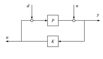
$$\begin{bmatrix} u \\ y \end{bmatrix} = \begin{bmatrix} K \\ I \end{bmatrix} (I + PK)^{-1} \begin{bmatrix} I & P \end{bmatrix} \begin{bmatrix} n \\ d \end{bmatrix}$$
